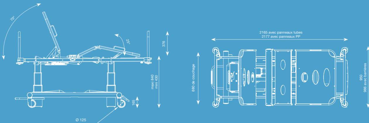
Lit à hauteur variable avec système d'élévation par colonnes
